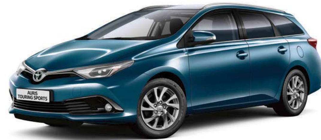
Auris Touring Sports Hybrid, 99 bg'lik 1.8 litre benzinli motor ve 82 bg güç üreten elektrikli motoruna sahip.
